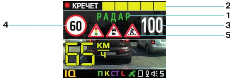
На окне оповещения об объекте базы данных демонстрируется следующая информация:
